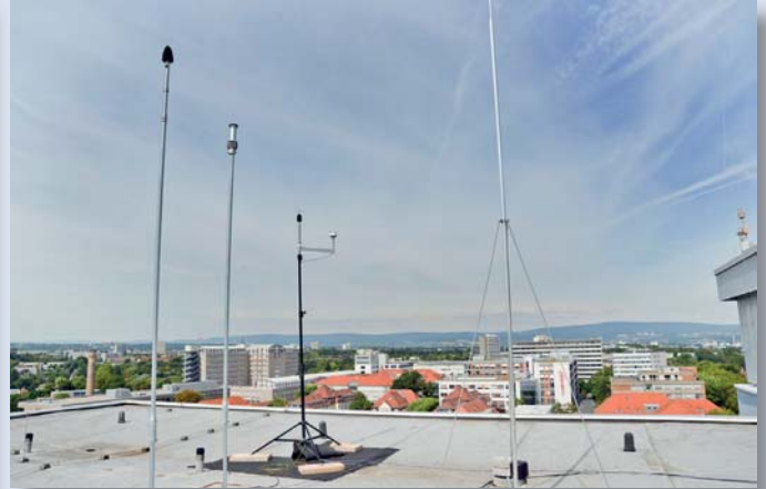
Fluglärmmessstation auf Geb. 102 der Universitätsmedizin Mainz in Höhe von 160 üNN
